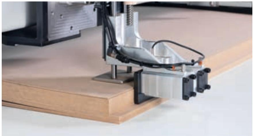
Das Ladesystem mit Greifern ermöglicht eine präzise und sichere Zuführung von Einzelplatten und mehreren Platten und steigert die Produktivität erheblich.
