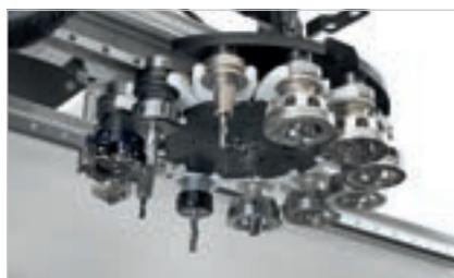
Revolvmagazin mit 12 Positionen am Kopf und 12 Positionen am Schlitten X, wodurch die Zykluszeiten auf ein Minimum verringert werden.
