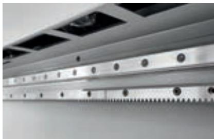
Verstärkte Zahnstangenführungen und Ritzel für die Bewegungen auf der X- und Y-Achse, die für die höchsten Geschwindigkeiten und Beschleunigungen der Kategorie sorgen, verleihen der Maschine große Stabilität bei den Bewegungen und erhöhen Präzisionsniveau und Bearbeitungsqualität.
